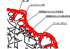
吹付工(特殊配合モルタルB 10kg吹) 標準施工図
